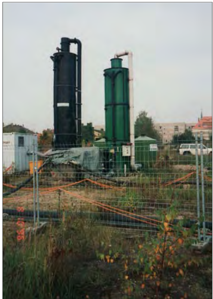
Abb. 8.3-11 Grundwassersanierungsanlage am ehemaligen Sachsenwerk
