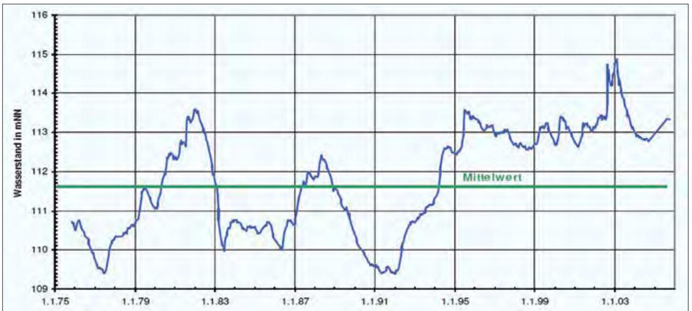
Abb. 6.1-3 Grundwasserstände einer GWM im Dresdner Osten (Messstelle 5049 1961, Meublitz, F.Schreiter-Straße) – deutlich erkennbar ist das Ansteigen der Werte nach 1990 /6.1-1/
